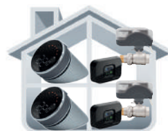
2. Dos zonas con 2 iT 800 y control de 2 válvulas motorizadas
