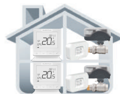
2. Dos zonas con 2 iT 700 y control de 2 válvulas motorizadas
