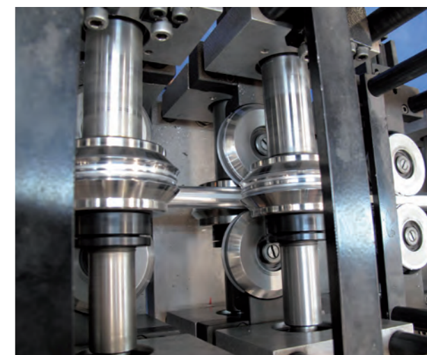
Aplicación de lámina de aluminio sobre el tubo base de PE-RT.
